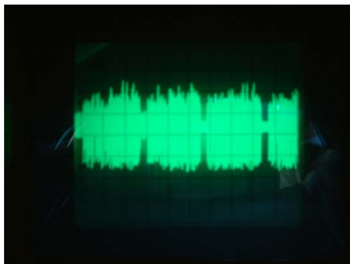
Abb. 2-1: Die vier Zeitschlitze des TDMA-Rahmens einer TETRA-Basisstation, die Frequenz der Zeitschlitz-Pulsung beträgt 70,6 Hz.
